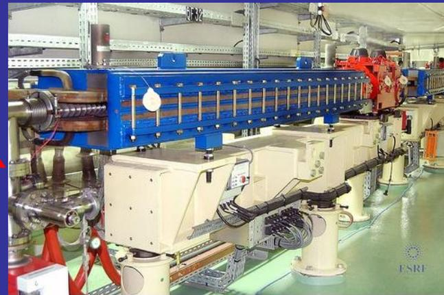
Quand le champ est minimum dans les dipoles, cela définit le « T0 »: le 'top-départ' du système de timing qui gère toute la chaîne d'injection/extraction
