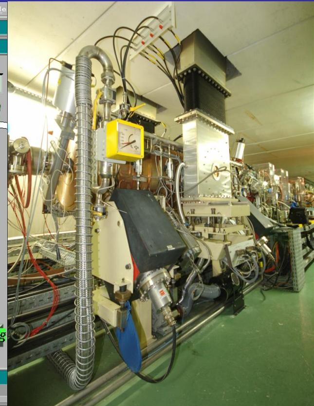
Rôle: compenser l'énergie perdue tour par tour par les électrons, par suite de l'émission du rayonnement synchrotron, c-à-d, 4.8 MeV (avec les éléments d'insertion)
