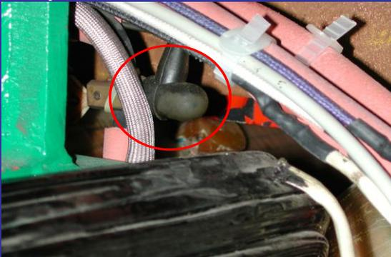
Diagnostic: Le caoutchouc protecteur du capteur se liquéfie sous les radiations.
