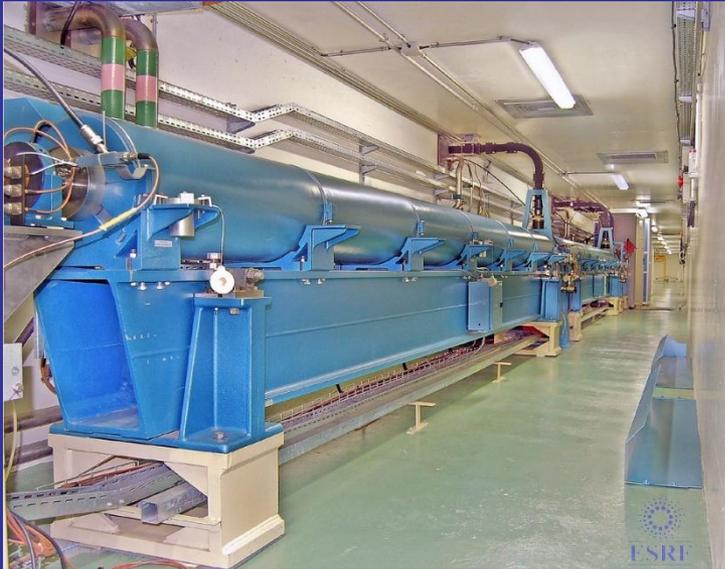
Le Linac consiste en une **TRIODE** (cathode – anode – grille) alimentée par 100 KV. Les électrons produits ont donc une énergie de 100 keV. Les électrons sont ensuite accélérés par 2 sections accélératrices de 6 mètres chacune, chaque section accélérant le faisceau de 100 MeV, soit au total 200 MeV.
